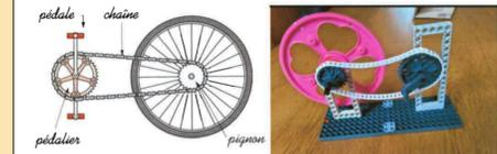
Conclusion : Pour faire avancer le vélo, on appuie sur les pédales qui mettent en rotation le pédalier (roue dentée). Le pédalier entraîne la chaîne qui met à son tour en rotation le pignon (roue dentée) fixé sur la roue arrière. Ainsi la roue arrière se met à tourner.
